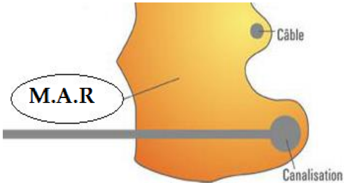
Figure 4 | Remplissage de tranchées irrégulières avec un MAR
