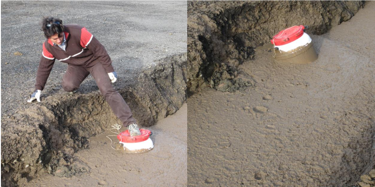
Figure 7 | Essai de flottabilité avec un fût de 80 litres rempli d'eau représentant un mannequin
